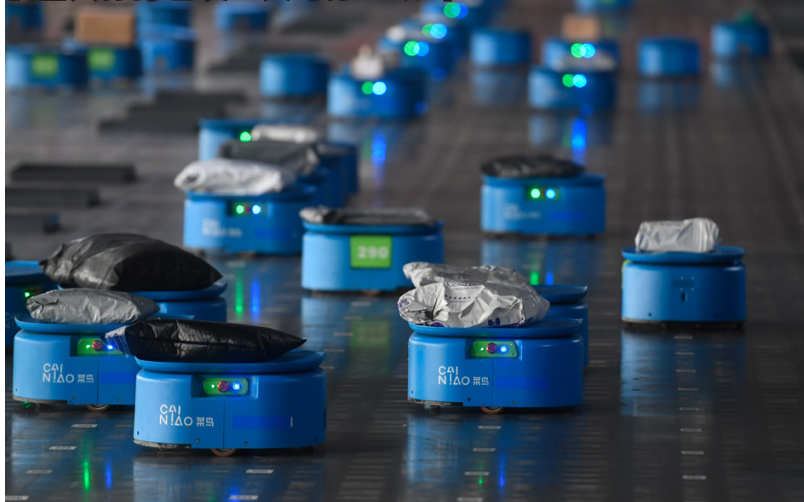
9月14日，在圆通速递杭州转运中心的超级机器人分拣中心，机器人在操作平台上将包裹运到对应区域格口。
