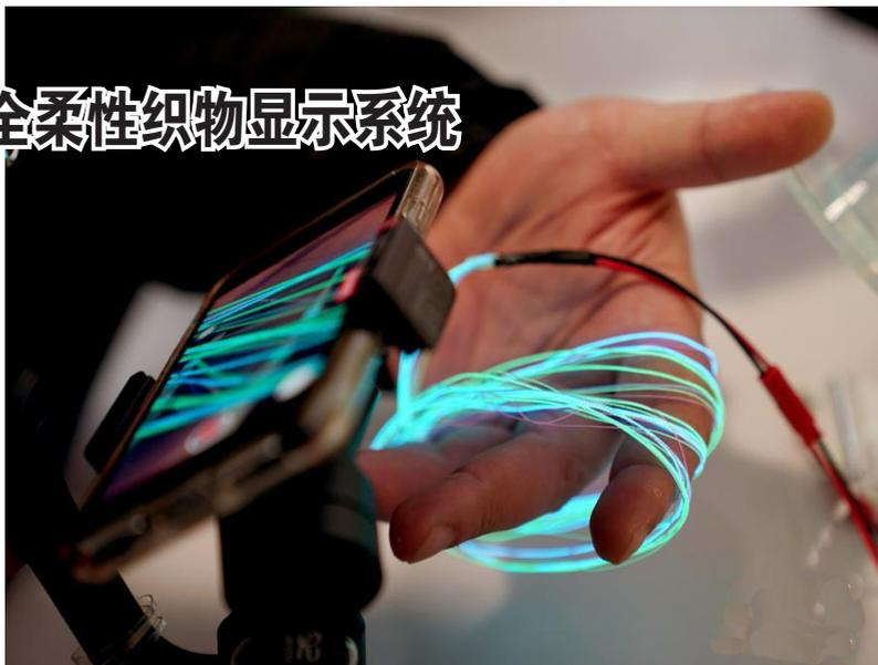
0.2毫米至0.5毫米间精确调控，赋予了其超细超柔的特性，以此梭织而成的衣服，可紧贴人体不规则轮廓，并保证轻薄、透气。同时，团队在“导电纬线”的力学性能上下足功夫，研制出的高弹性透明高分子导电纤维可在与“发光经线”交织时发生自适应弹性形变，从而形成稳定接触界面。
