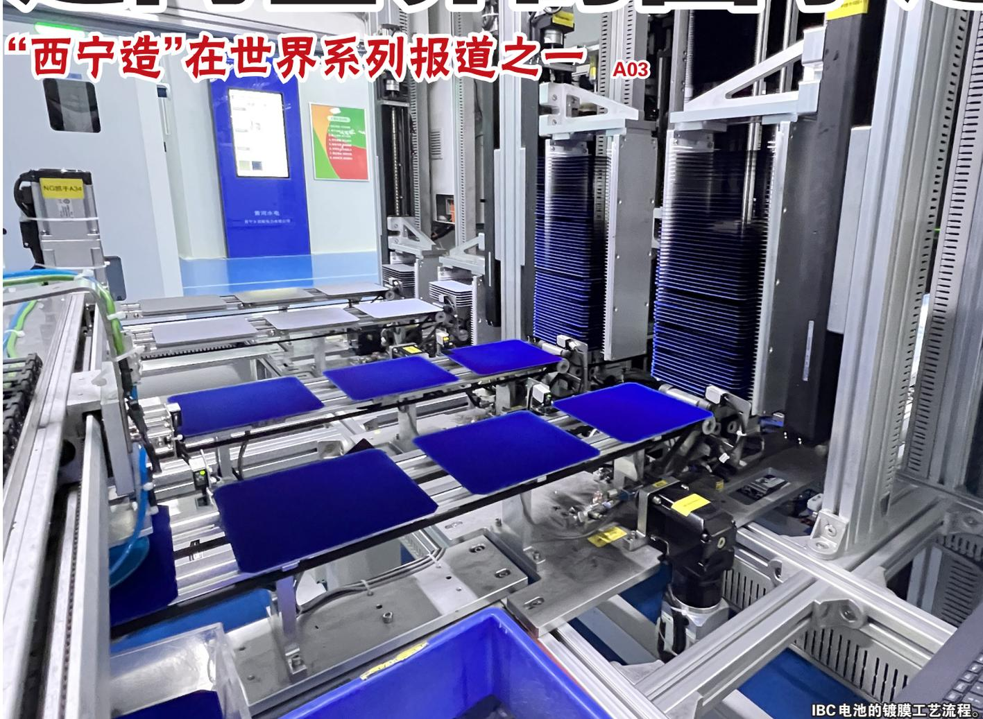
IBC电池的镀膜工艺流程。
