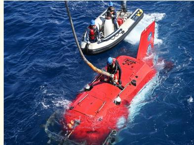
潜航员为“深海勇士”号载人潜水器解开与“探索一号”科考船相连的缆绳，为“深海勇士”号载人潜水器下潜做准备(2023年5月26日摄)。新华社记者 蒲晓旭 摄
