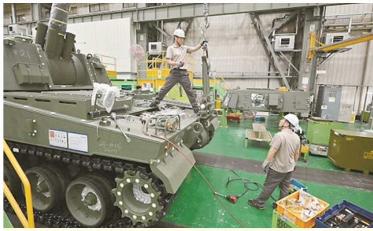
15日，韩国韩华航空航天公司工厂正加紧生产K-9自行榴弹炮。
