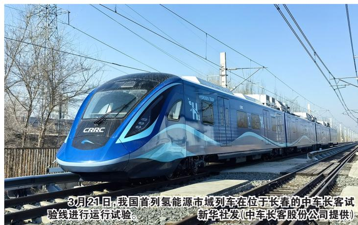
3月21日,我国首列氢能源市域列车在位于长春的中车长客试验线进行运行试验。新华社发(中车长客股份公司提供)
