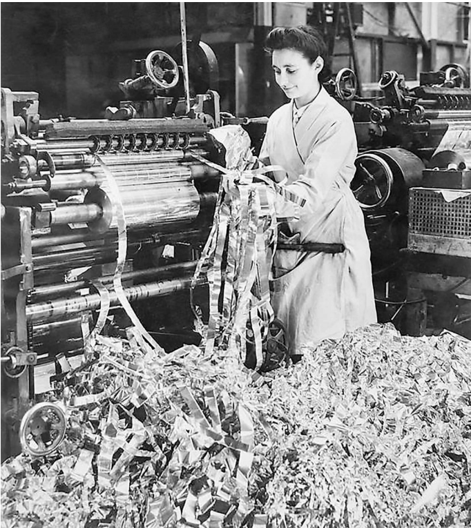
盟军工厂的工人正在生产在空中干扰敌方雷达的箔片。
